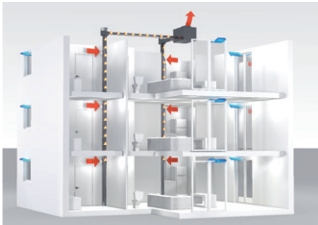
Aereco bedarfsgeführtes Abluftsystem im Mehrfamilienhaus
